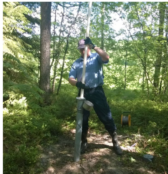
ARTO PULLINEN, GTK, MITTAA SLUG-TESTILLÄ OHENMÄEN MAAKERROSTEN VEDENLÄPÄISEVYYTTÄ.
